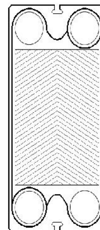
LU Litera U oznaczająca przetłoczenie jest skierowana w górę. Pierścień w dół w lewo.
